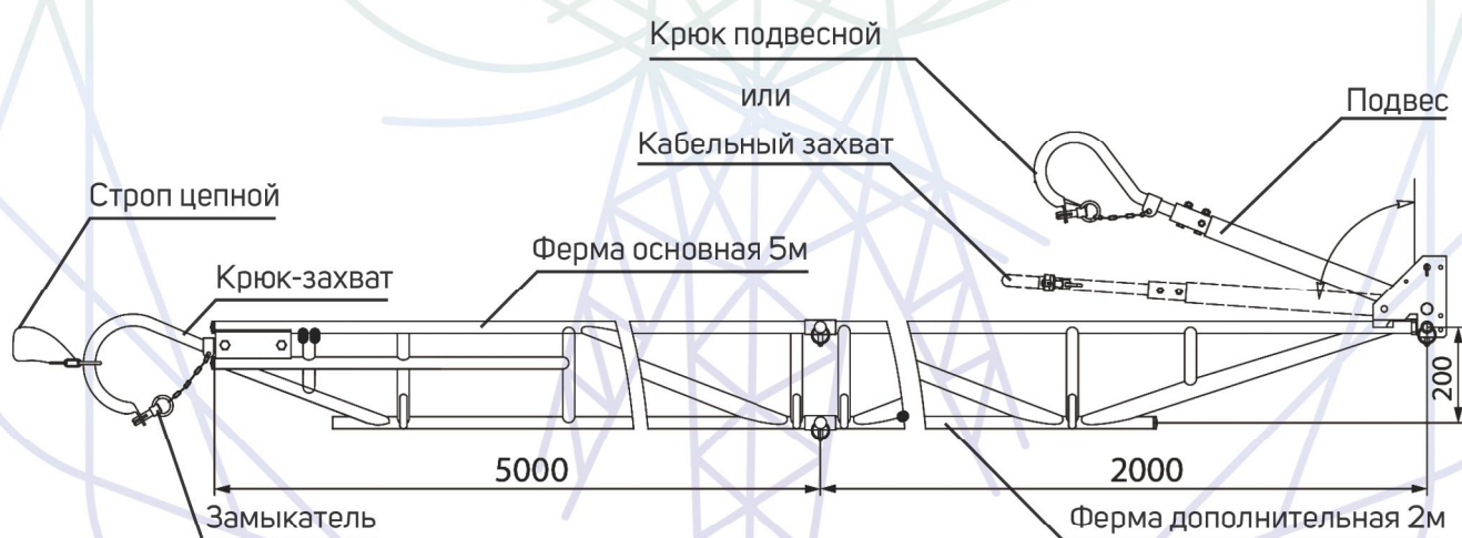
Конструкция трапа ТРМЛ-0,3-5+2. Размеры указаны в миллиметрах
