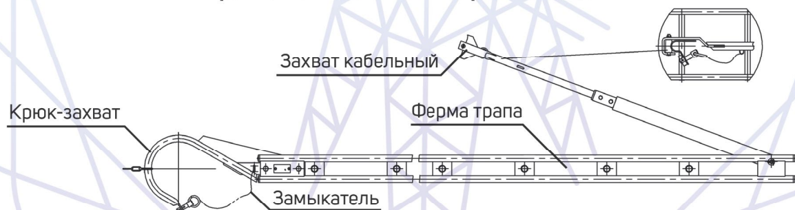
Трап монтажный типа ТРЛ с кабельным захватом
