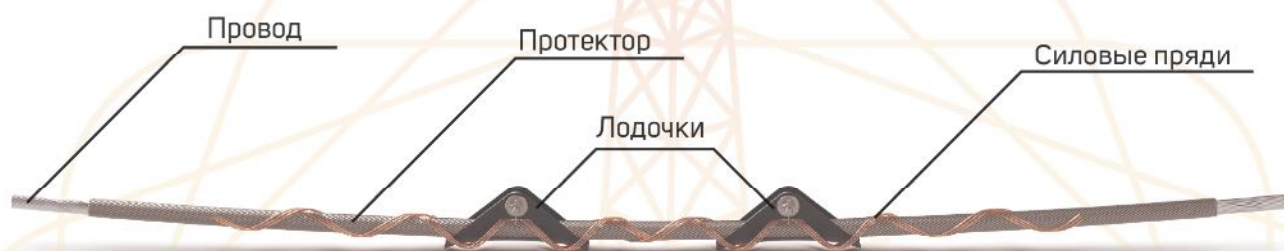
Поддерживающий зажим типа ПС-Dmin/DmaxП-14-2Л(L)-ТРИАС с двумя лодочками
