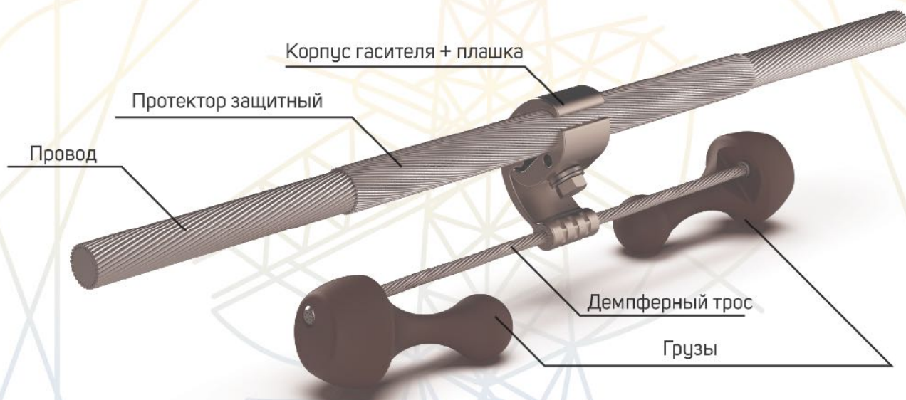
Многочастотный гаситель вибрации ГВ-Х1Х2Х3Х4-02-ТРИАС
