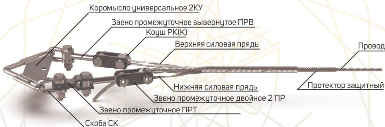
Общий вид натяжных зажимов НС-Dmin/Dmax(П)-Х1Х2(Рз)-НП(Рз)-ХЗ- ТРИАС, состоящих из нескольких силовых прядей с комплектом дополнительных установочных элементов.
