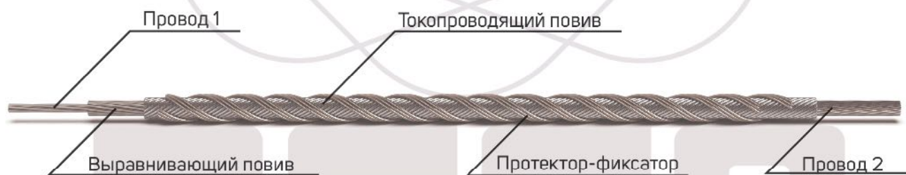
Соединение проводов разного диаметра зажимом шлейфовым типа ШС
