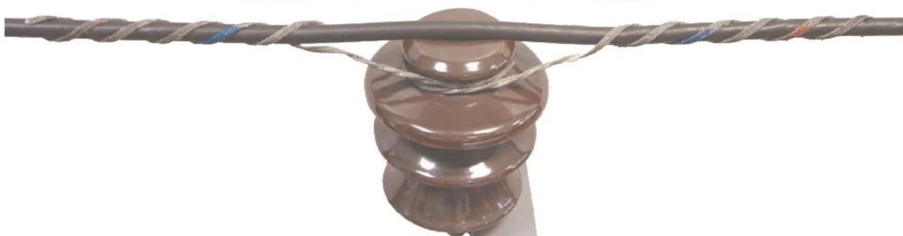
Натяжная вязка модификации 2 для двойного крепления.
