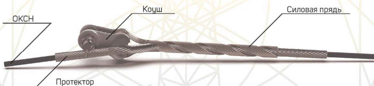
Зажим натяжной спиральный типа НСО-Dmin/DmaxП-01(Рз)-ТРИАС
