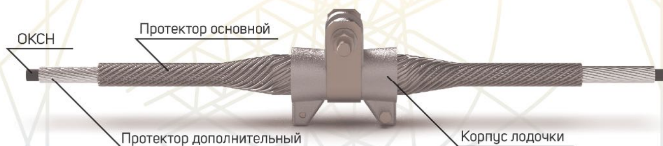
Зажим поддерживающий типа ПСО-Dmin/DmaxП-04-ТРИАС
