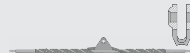
Зажим поддерживающий спиральный ЗПС-Млс для ОКГТ, ГТ, ГТК, МЗ, проводов типа АС и ОКСН
