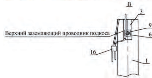
Схема 1 установки на ВЛЗ А10МИ-3 в качестве анкерной опоры
