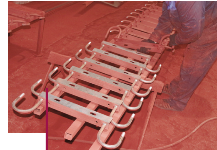
Малярный цех: нанесение грунтового покрытия ГФ-021
