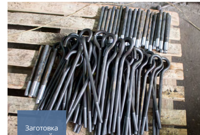
Результат работы: готовые к финишной покраске траверсы нестандартного типа.
