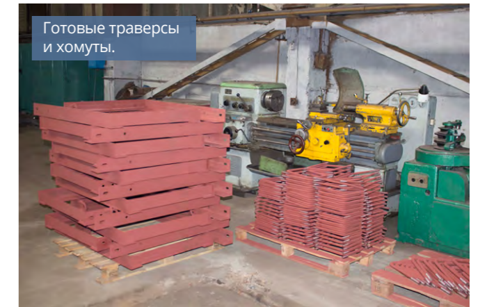
Результат работы: готовые к финишной покраске траверсы нестандартного типа.
